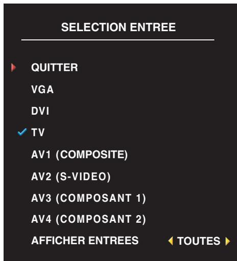
**VGA** — Sélectionnez VGA lorsque votre écran de téléviseur est utilisé en tant que moniteur informatique et connecté à l'ordinateur par un câble VGA.
